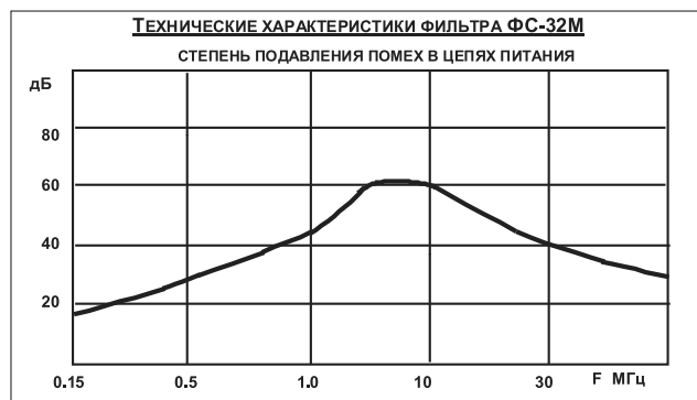
График АЧХ фильтра ФС-32М
