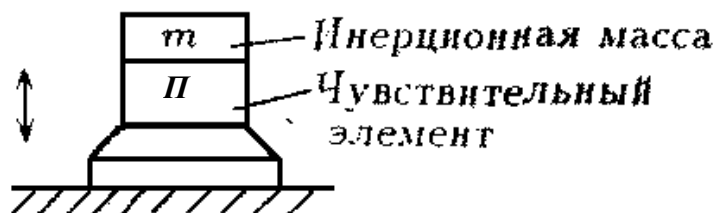
Рис.3.1. Простейшая конструкция виброакселерометра
