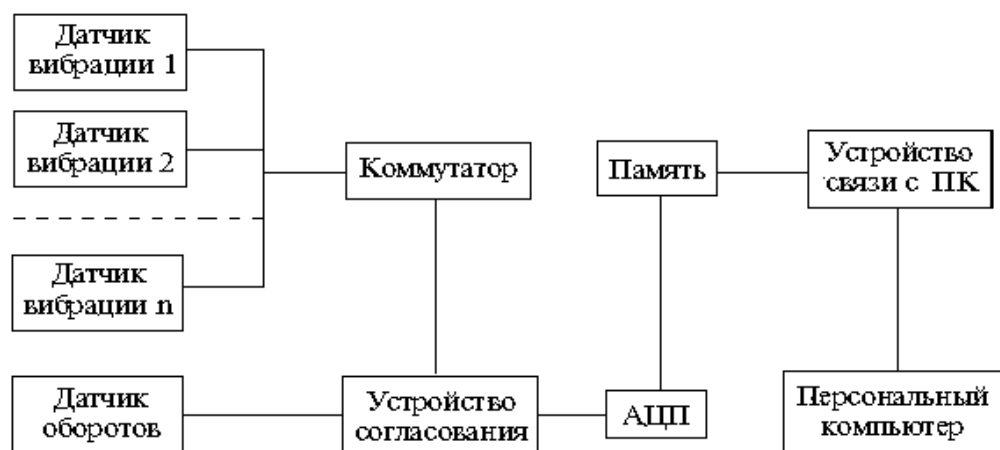
Рис.5.6. Структура входного устройства. АЦП - аналого - цифровой преобразователь.
