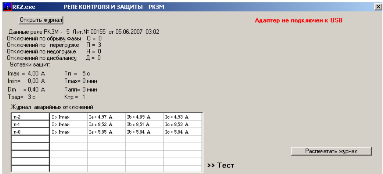
Рисунок 9 – отображение журнала аварийных отключений на экране ПК
