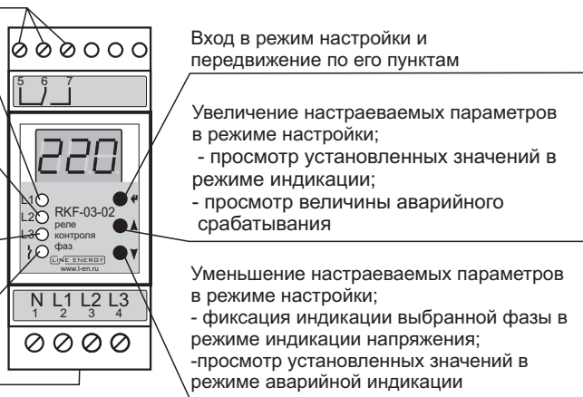
Рис 1. Устройство прибора
