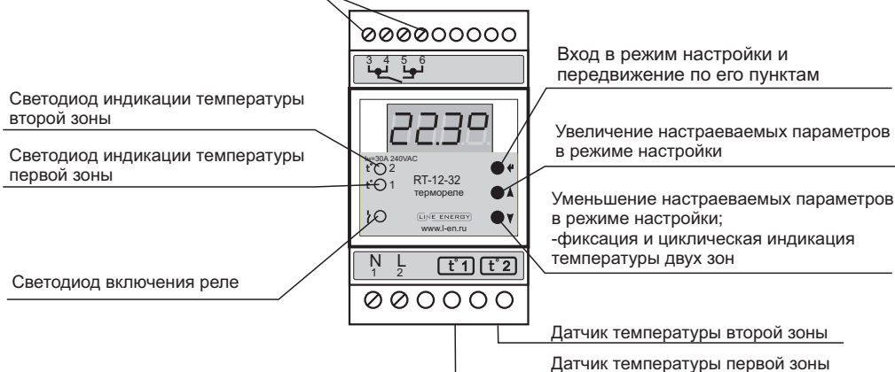
Рис 1. Устройство прибора
